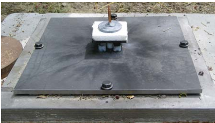
Rys. 1. Stanowisko do badań pakietów elementów cylindrycznych Fig. 1. Experimental stand, allowing tests a set of cylindrical tubes elements
