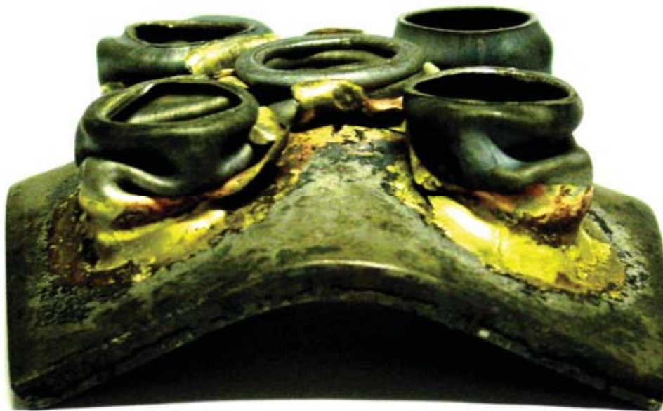
Rys. 18. Zdeformowany pakiet poddany działaniu fali ciśnienia powstałej w wyniku detonacji 40 gramów MW
