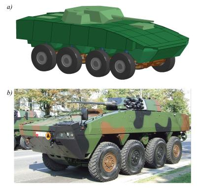
Fig. 3. Armoured Personnel Carrier Rosomak: a) model; b) actual vehicle
