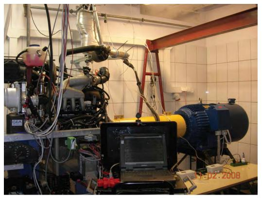
Fig. 3. Engine test stand
